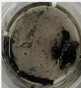
분산제 및 희석배지 첨가만으로 검액을 제조할 때 충분히 균질화되지 않은 검액 예시
